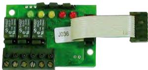
Tarjeta enchufable de 3 relés para detectores SMART 3 GC y SMART3NC. Relés a 12 ó 24Vcc.
